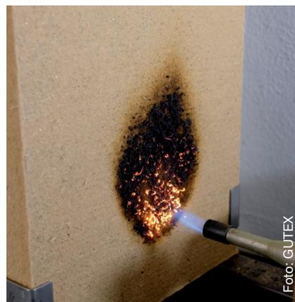
GUTEX Pyroresist ist die erste schwer entflammare und nicht glimmende Holzfaserdämmplatte der Welt!
