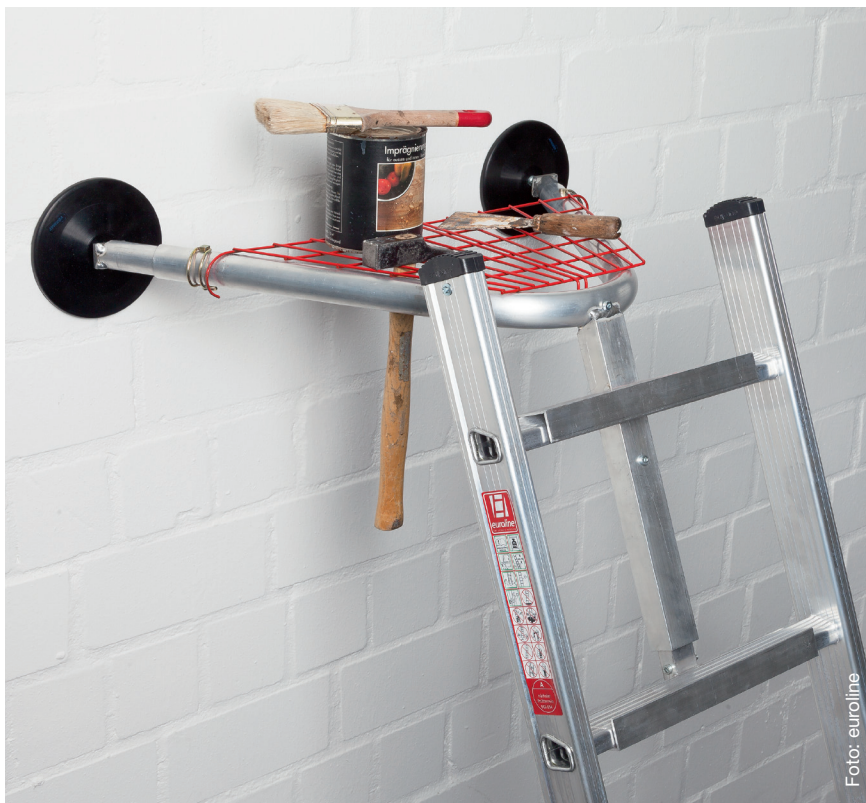
Wandabstandshalter mit Tellerfüßen: Gute Verteilung des Anlegedrucks, ideal für Wärmedämmfassaden, Glasfassaden oder LKW.
