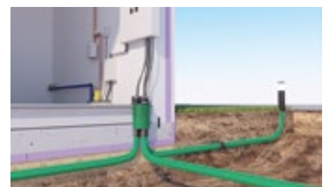
Leerrohre ermöglichen die nachträgliche Belegung mit Versorgungskabeln
