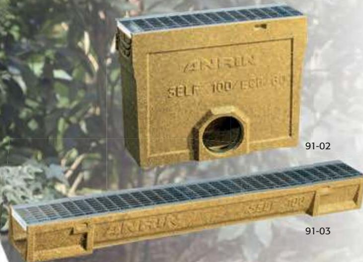
**Der Bausatz** besteht aus Rinnenelementen (1 m), Ausgleichsstücken (50 cm), Stirnwänden als Rinnenstrangabschluss und einem Einlaufkasten mit Schmutzfangeimer und Anschlussöffnung (50 cm). Als Helfer für den Anschluss an die Rohrleitung haben die Entwickler von ANRIN eine Rinnenvariante mit Rohrstützen entwickelt. Damit lässt sich der passgenaue Anschluss mit wenigen Handgriffen herstellen.
